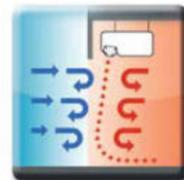
Eine Luftschleieranlage wirkt dem Kaltluft einfall mit einer Gegenströmung entgegen – eine unsichtbare Tür aus Luft.
